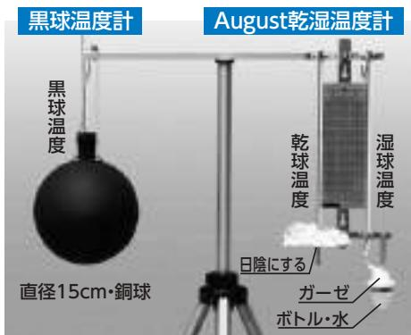
図① August乾湿温度計と黒球温度計
